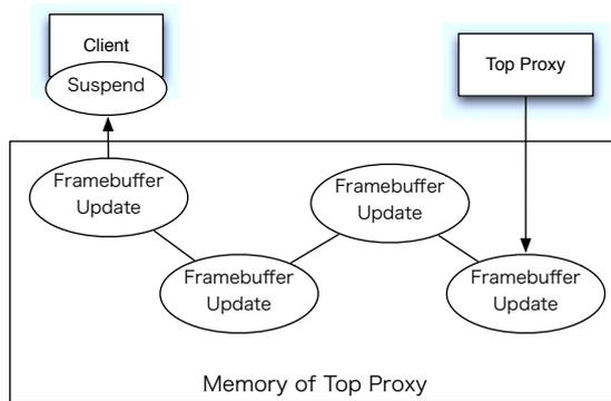
図 4 クライアントサスペンド時の Top のメモリの様子。
