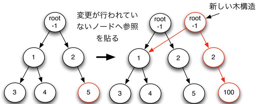
図 3.6: 非破壊的木構造の編集 4
