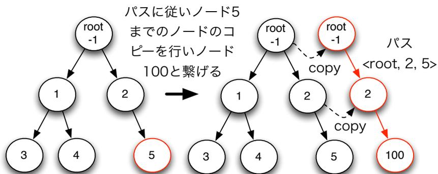
図 3.5: 非破壊的木構造の編集 3
