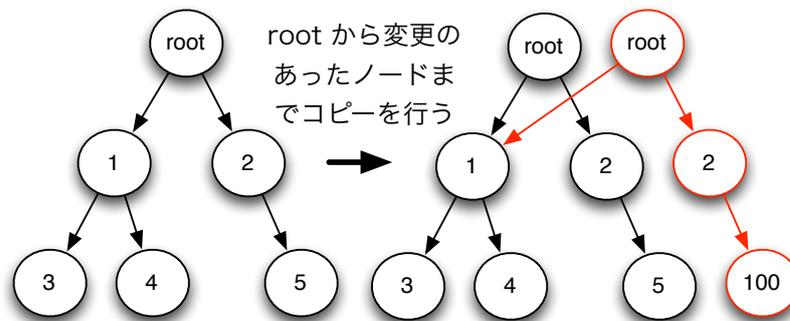
図 3.2: 非破壊的木構造の編集
