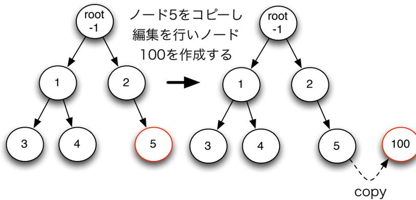
図 3.4: 非破壊的木構造の編集 2
