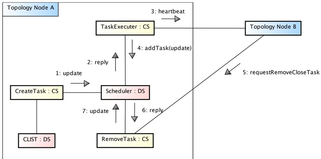
図 4.1: keepAlive の仕組み
