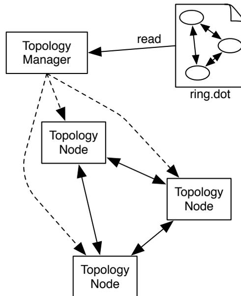
図3: Topology Manager はトポロジーファイルの記述に従ってトポロジーを生成する
