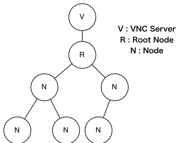
図 3.6: TreeVNC, AliceVNC の構造
