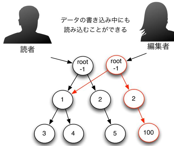
図 3.3: 非破壊的木構造による利点
