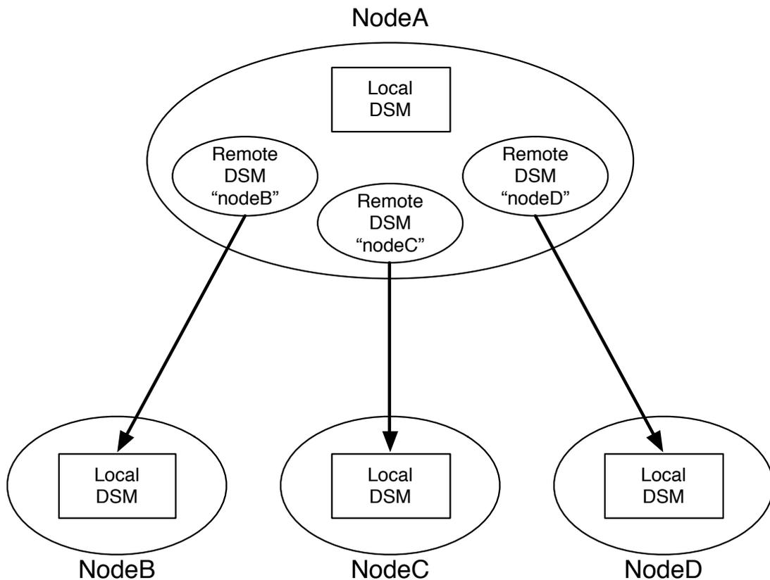
図 2.2: Remote DSM は他のノードの Local DSM の proxy
