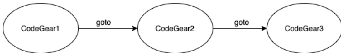
図 2.1 goto による軽量継続を用いた CodeGear 遷移
